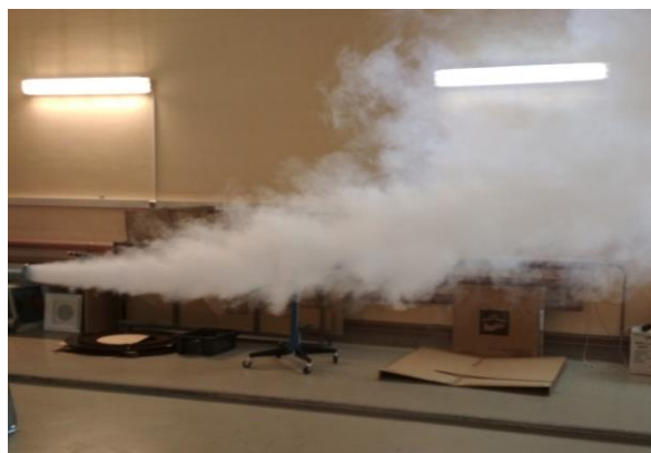
Рис. 1. Демонстрация развития приточной нагретой струи (иллюстрация авторов) Fig. 1. Demonstration of the flow of the supply heated jet (illustration by the authors)
